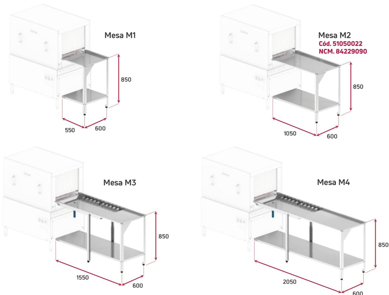
\*Fotos ilustrativas sem escala. Altura contabilizada da superfície de trabalho até o piso. Dimensões em milímetros.
